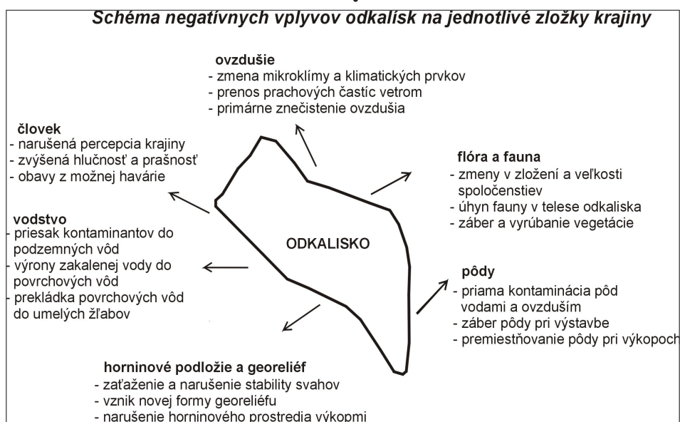
Obr. 7 Schéma negatívneho vplyvu odkalísk na jednotlivé zložky krajiny
